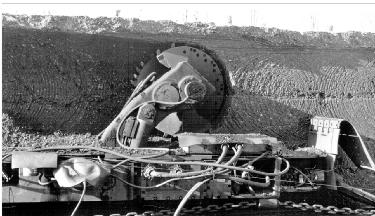
Комбайн 1ГШ68 с измерительными тензоузлами на стенде с углещементным блоком (ГМЗ им. Кирова, 1973 г.)
