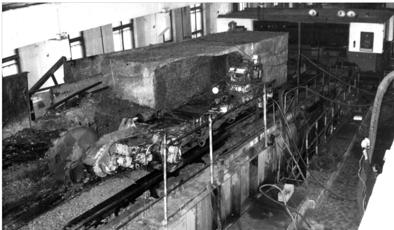
Комбайн РКУ13 с измерительными узлами на стенде с углецементным блоком (1986 г.)
