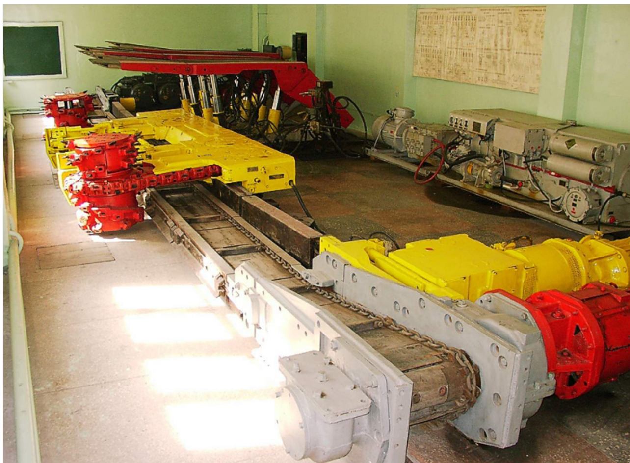
Действующий учебно-технический стенд на базе очистного комплекса МКД90
